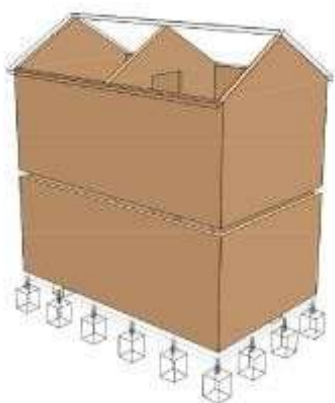
Placas verticales: Muros
