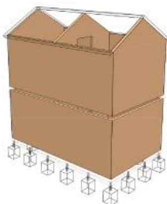
Placas verticales: Muros
